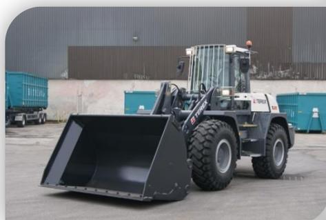
Chargeuse : pour charger le broyeur et le cribleur, déplacer les tas de végétaux sur la plate forme de compostage.
