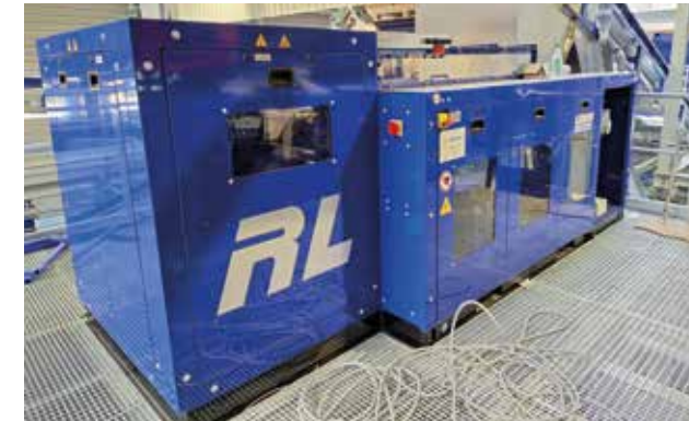
Un séparateur à courant de Foucault dernier cri permettra de collecter les petits aluminiums.
